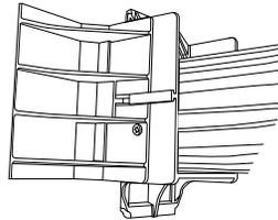
**De fuerza añadido:** Conducir un tornillo de la cubierta de **1 ½ - 2 pulgadas** por el lado de cada apoyo y en el centro de la viga, unificación del sistema.
